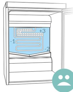
Herkömmlicher Kühlschrank mit Verdampfer im Innenraum. Dieser erzeugt Kälte, indem das Kältemittel verdampft und dadurch Abwärme erzeugt, die an die Umgebung abgegeben wird.
