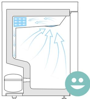
Der BioCompact 210 Kühlschrank mit Lamellenverdampfer. Das Kältesystem mit eingebautem Lamellenverdampfer sorgt für eine gleichmäßige Temperaturverteilung im Kühlschrank und damit für eine stabile Temperatur auf der gesamten Lagerfläche.
