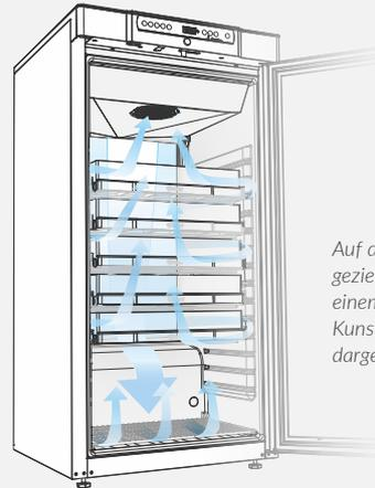
*Auf dem Bild wird die gezielte Luftführung in einem BioCompact II mit Kunststoffschubladen dargestellt.*
