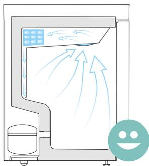
L'armoire BioCompact 210 avec un évaporateur tubes/ailettes favorise la circulation de l'air canalisé à l'intérieur de la zone de stockage, diffusant l'air froid et assurant ainsi un température stable et homogène.
