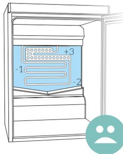
Le réfrigérateur ménager avec l'évaporateur dans la zone de stockage.
