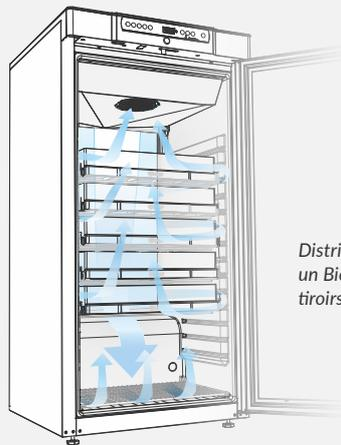
*Distribution d'air canalisé dans un BioCompact II avec des tiroirs ABS.*
